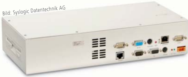
Bild 2: Ein kundenspezifisches Retrofit-Gerät, das mit einer Floppy-Schnittstelle ausgerüstet wurde.
