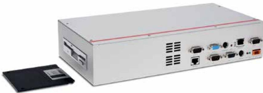
Mit den Retrofit-Computern von Syslogic lassen sich nicht mehr produzierte Systeme ersetzen, ohne dass Softwareanpassungen nötig werden. Hier ein kundenspezifisches Gerät mit Floppy-Schnittstelle.
