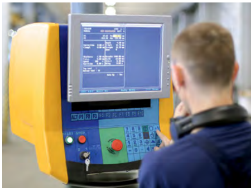
Wird eine Anlage mit dem Hauptschalter ausgeschaltet, sorgt das intelligente Power Management im Hintergrund für das geregelte Herunterfahren des Steuerungsrechners. Alle Abb.: Syslogic
